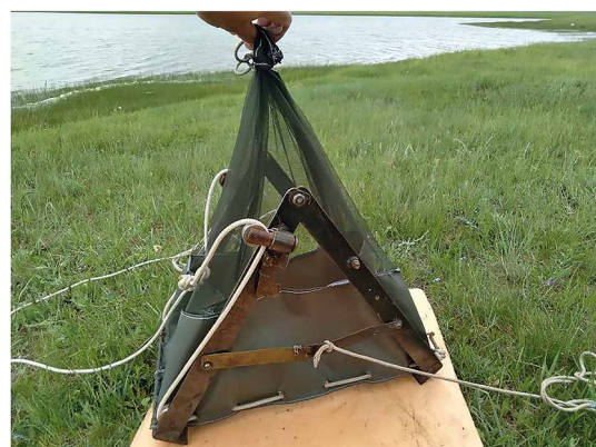
Рис. 2. Прибор для количественного учета гаммарид (КУГ)
