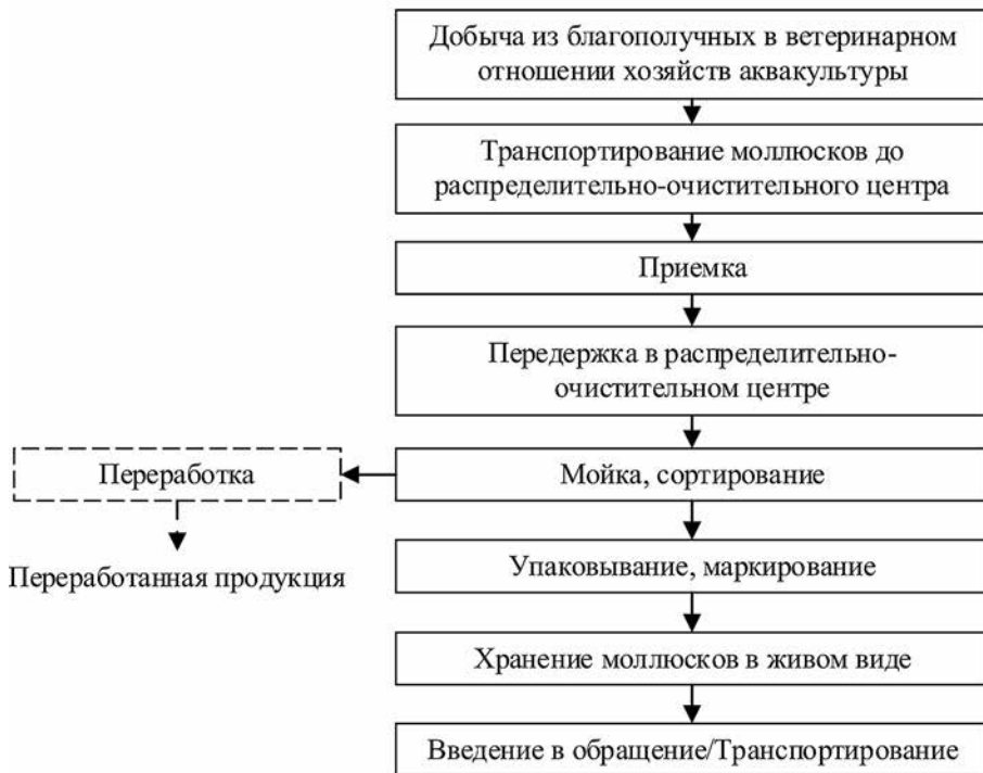
Рис. 1. Технологическая схема производства живых двустворчатых моллюсков, составленная с учетом ТР ТС 021/2011, ТР ЕАЭС 040/2016
