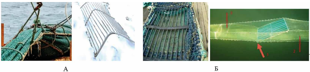
Рис. 1. Типичные недостатки существующих сортирующих систем: А — промысловая операция с тралом на палубе судна приводящая к деформации селективных решеток; Б — деформация сетной оболочки, направляющей и подъемной панелей сортирующей системы в процессе траления: 1 — Перекрывание решеткой периметра сортирующей системы; 2 — Залегание подъемной панели; 3 — Деформация верхней части трала за направляющей панелью
