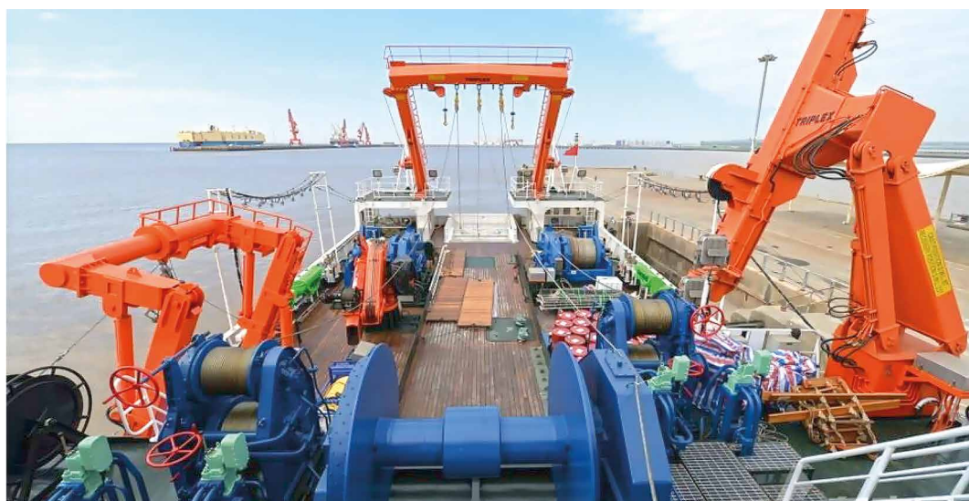
Рис. 2. Вид траловой палубы и добывающего оборудования НИРС «Song Hang»
